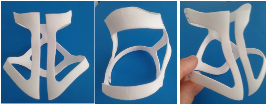
Figura 35. Prototipo del corsé a escala con poliamida (SLS)
