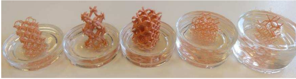
Figura 19. Probetas con estructura para pruebas de colada
