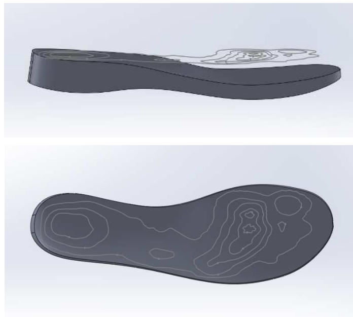
Figura 6. Unión de los contornos de carga con la suela.
