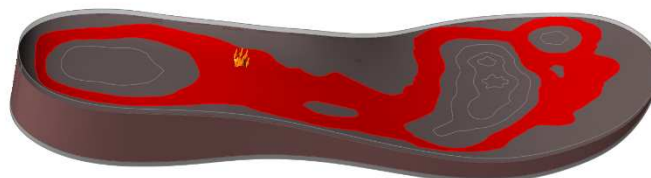
Figura 9. Aplicación de la carga de 10 kPa
